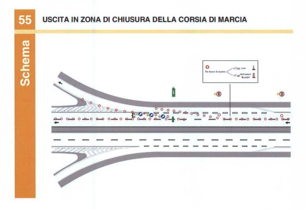
3) che durante le ore notturne ed in tutti i casi di scarsa visibilità le barriere regolamentari di testata della zona di lavoro devono essere munite di idonei apparati luminosi di colore rosso a luce fissa, così come il segnale
