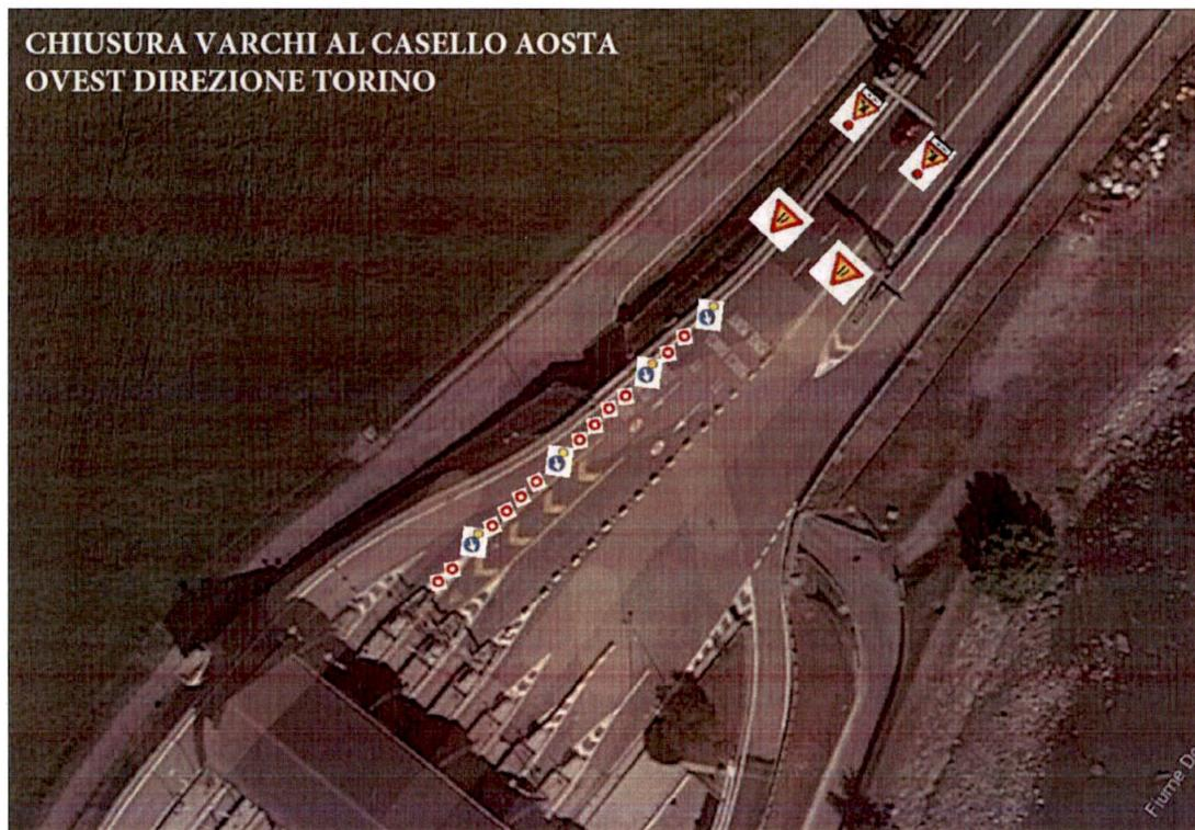
5) che la chiusura dei rami di svincolo in ingresso alla Stazione di Aosta Ovest sia effettuata mediante integrazione di segnaletica come descritto nello schema di seguito riportato:
