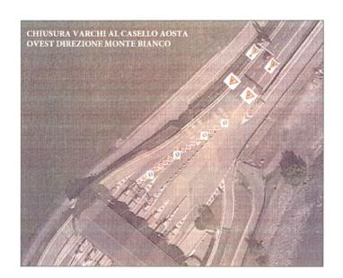
4) che la chiusura dei rami di svincolo in ingresso alla Stazione di Aosta Ovest sia effettuata mediante integrazione di segnaletica come descritto nello schema di seguito riportato:
